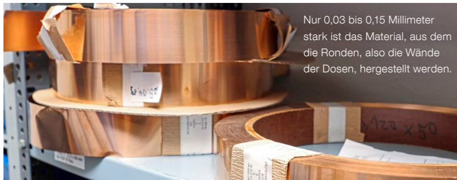
Rohlinge für Aneroidkapseln aus eigener Herstellung. Die Ringprägung bestimmt die Eigenschaften der Dose.
