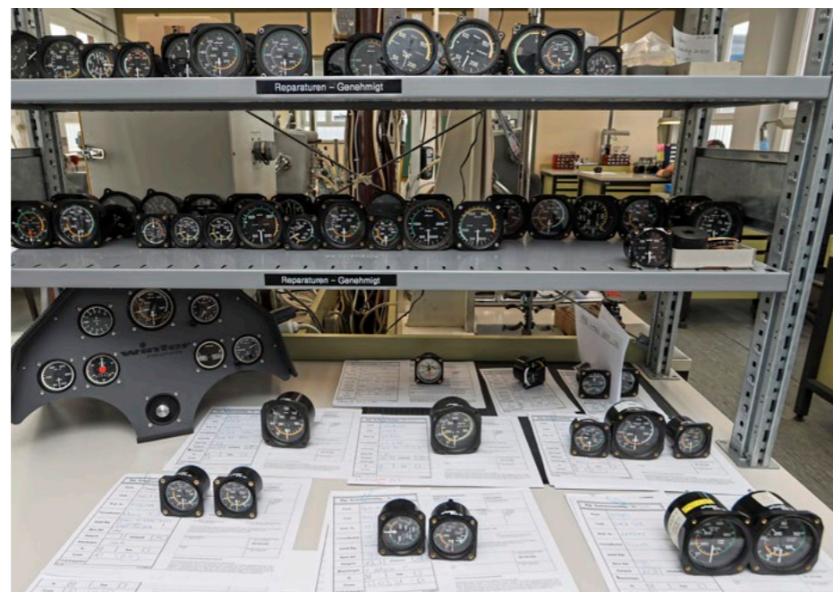
Fahrtmesser harren ihrer Überprüfung und gegebenenfalls Reparatur. Einen groben Kostenvoranschlag gibt es bei Winter gratis, erst nach Auftragserteilung beginnen die Arbeiten.
